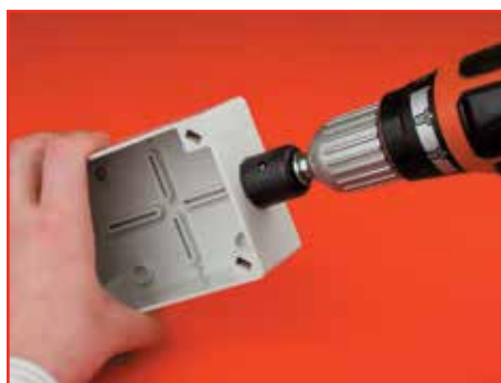
Сверлим отверстия необходимого диаметра
