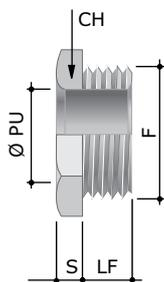
**Назначение:** ответвление и вывод кабелей из коробок и металлических лотков с целью предохранения оболочки кабеля от прорезания острой кромкой.
