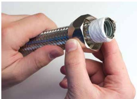
1. Вначале следует одеть на металлорукав зажимную гайку.
