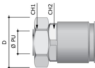
**Назначение:** герметичное соединение жестких стальных труб с металлорукавами.
