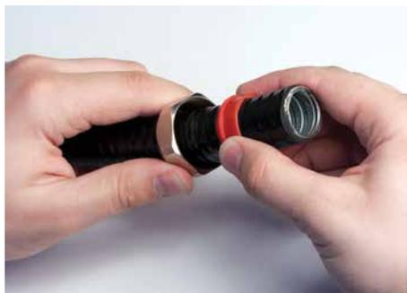
1. Вначале следует одеть на металлорукав зажимную гайку, затем зажимное уплотнительное кольцо красного цвета. Уплотнительное кольцо одевается стороной с утолщением под зажимную гайку.
