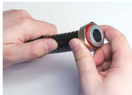
3. Сдвиньте гайку и уплотнительное кольцо на край металлорукава.
