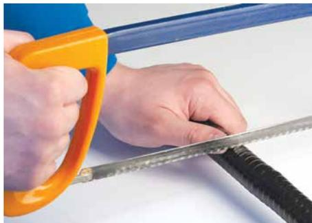
Металлорукав можно отрезать с помощью ножовки по металлу, ленточной пилы и угловой шлифовальной машинки. Использование тисков позволяет сделать рез более точным и аккуратным. Рез осуществляется вертикально, что облегчает дальнейший ввод металлорукава в аксессуар.
