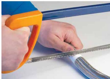
Для облегчения резки металлорукава в оплетке рекомендуем плотно обмотать место реза самоклеющейся лентой или скотчем до начала работ. Рез производить вертикально и по середине наклеенной ленты. Указанные действия позволят сделать рез аккуратным и при этом защитить пальцы от повреждений при дальнейшем монтаже аксессуара.
