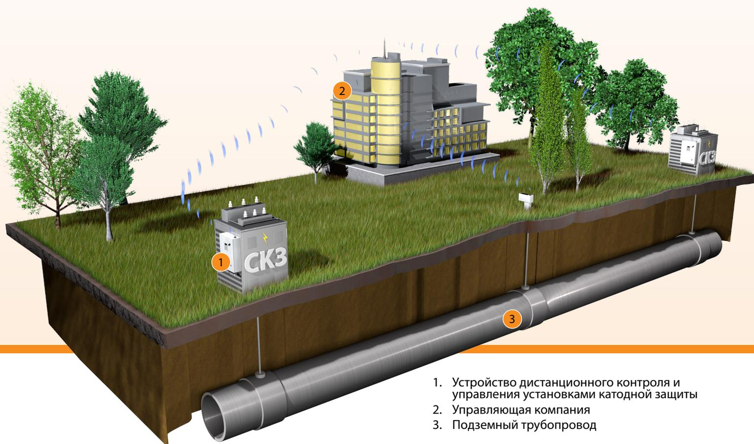
1. Устройство дистанционного контроля и управления установками катодной защиты
