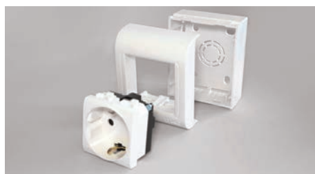
1. Коробки типа PDD для ЭУИ "Brava", 45x4мм. Розетки монтируются защелкиванием (без рамок и каркасов). С 4-х сторон коробки имеют преперфорацию под все типоразмеры миниканалов серии TMC
